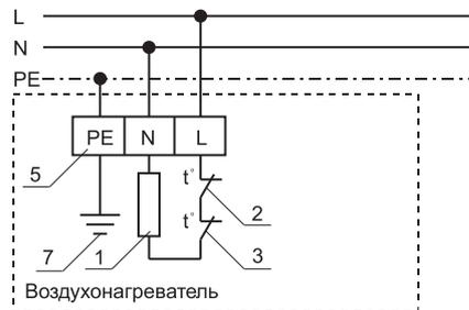
Мощностью от 0,5 до 3 кВт (схема 2)
